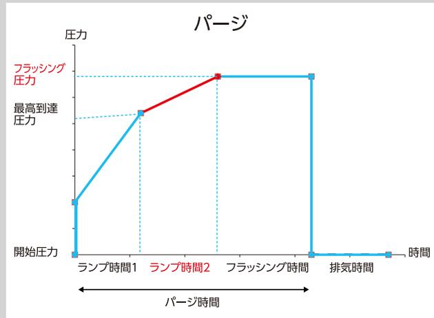
ガッシングヒータは、ルーバー社が自社開発した熱効率の高い、専用ヒータです。ガッシング圧力・時間は電空比例弁によって、任意に設定が可能です。また、独自に開発したパージエア用アルミ製ヒータ(特許取得済)によって、パージエア温度を110~150°Cまで任意に設定できます。この新しい技術は、世界各国で、アミン使用量・サイクルタイムの低減を実現しています。パージエアの圧力・時間も、電空比例弁によって、任意に設定が可能です。
