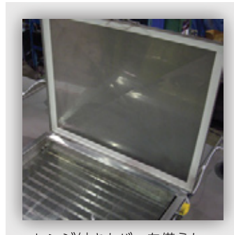
ヒンジ付きカバーを備えた、 脱着式の空気圧振動スクリーン
