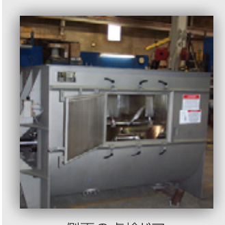
側面の点検ドア
