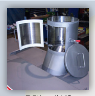
スクリーンおよび マグネットフィルタを備えた バルクバッグ入口ポート
