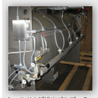
シールおよび排出バルブへの 圧縮空気ヘッド、および単相用の NEMA 4X-SSに準拠した ジャンクションボックス
