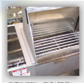
粉塵を抑制し、清掃が容易な 特製のブレンダーカバー
