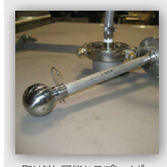
取り外し可能なスプレイボー ルを備えた、CIP洗浄用の3点 固定式フェール
