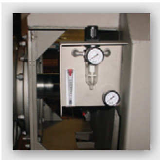
流量計を備えた 空気パージシール
