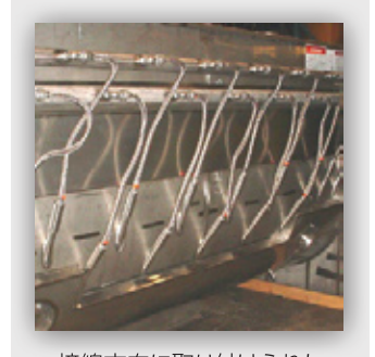
接線方向に取り付けられた CO2注入ノズルおよびマニ フォールド
