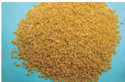
食品 高密度または多孔質構造の造粒 d=200 \mu m~5mm 例:可溶性のインスタント飲料、スープ粉末
