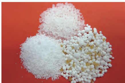
食品 高密度または多孔質構造の造粒 d=200 \mu m~5mm 例:可溶性のインスタント飲料、スープ粉末
