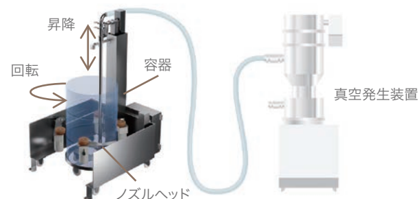
原料・製品に応じたノズルヘッドの形状
