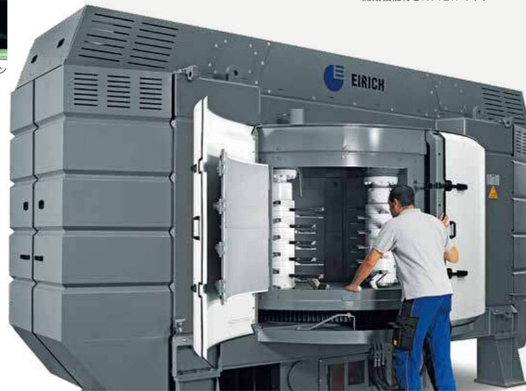
アクセスしやすいクロスヘッド開閉機能付きRV12Wミキサー
