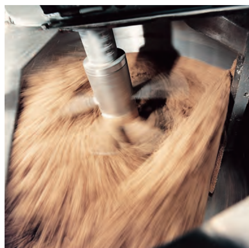
アイリッヒ インテンシブ ミキサー内の原料の動き
